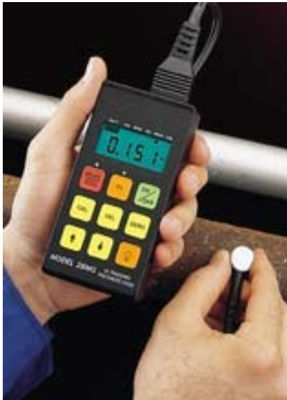
Рис. 42. Измерение толщины стенки трубы ультразвуковым толщиномером
