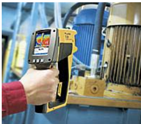
Рис. 45. Процесс обследования тепловизором работающего агрегата
