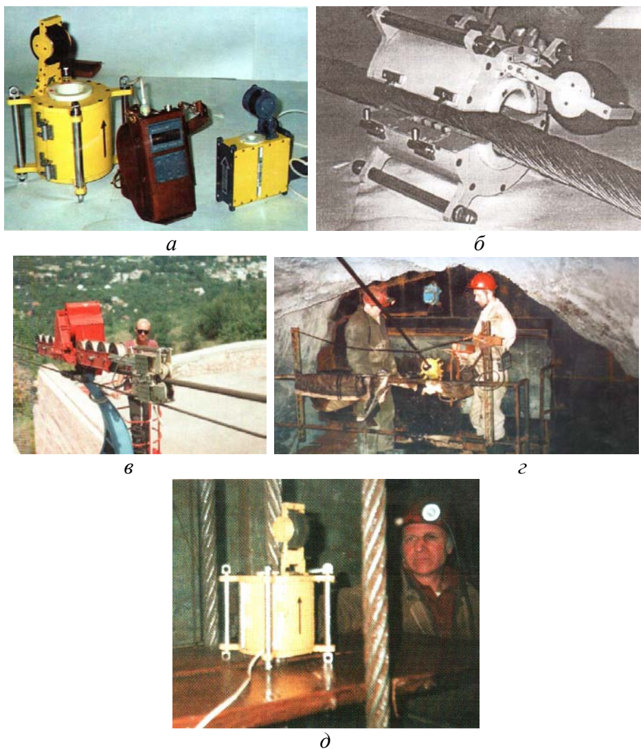
Рис. 20. Примеры контроля качества канатов: а – прибор «ИНТРОС МДК-21» в комплекте; б – установка головки МГ-64 на канат; в – контроль канатной дороги; г – контроль каната в угольной шахте; д – контроль каната в шахте пассажирского лифта
